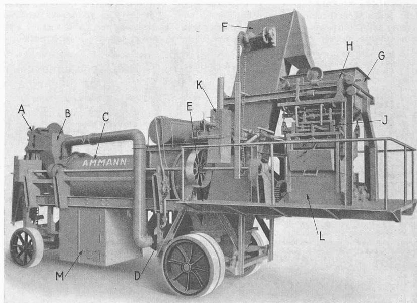
Abb. 7. Makadam-Maschine im Hof «Strassenbau», Gruppe II (vergl. Abb. 1 und 2)
