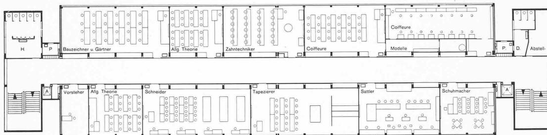
Abb. 3. Grundriss eines normalen Schulgeschosses (3. Obergeschoss), Masstab 1 : 500
