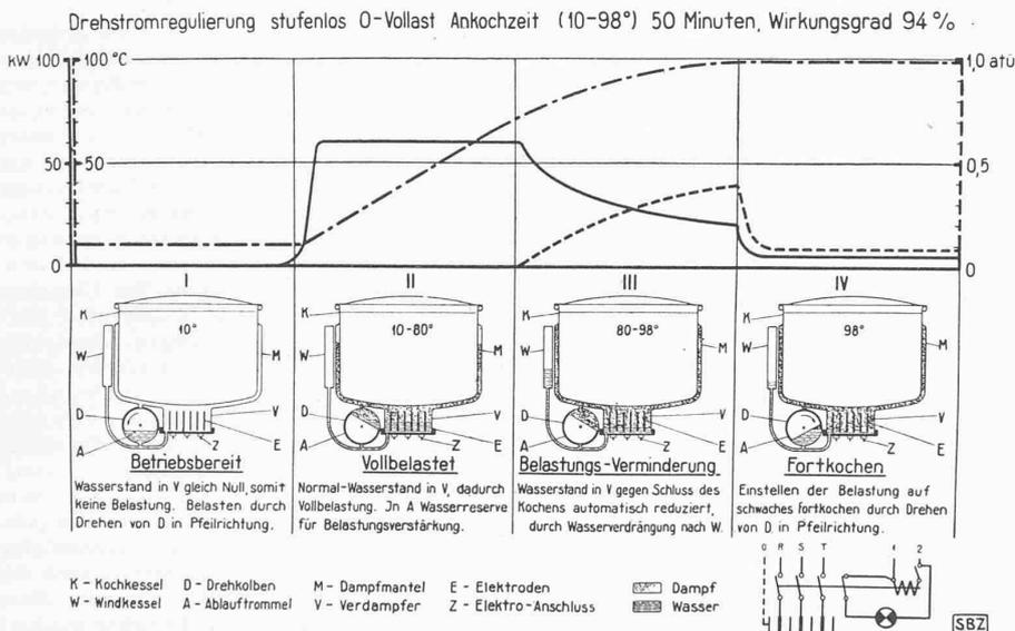
Abb. 12. Schemat. Darstellung der Vorgänge im Elektroden-Niederdruck-Dampfkessel System Therma
