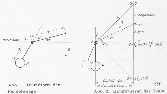
Abb. 1. Grundform der Pendelwaage
