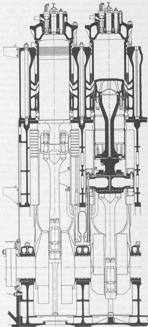
Abb. 2. Längsschnitt durch zwei Zylinder einer Hauptmaschine
