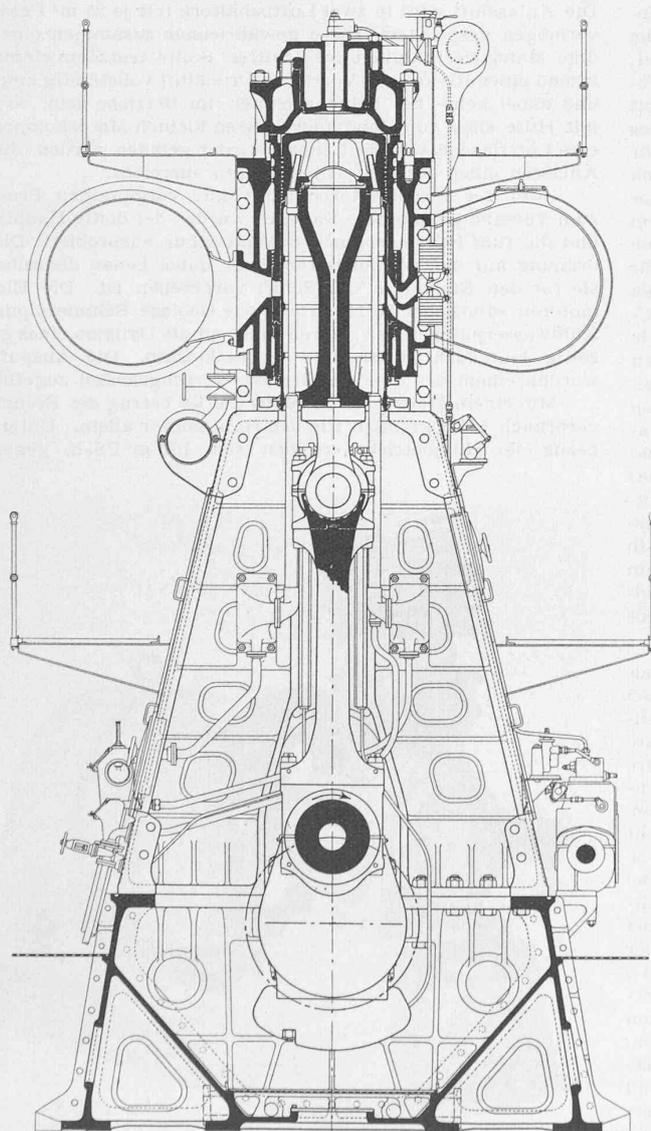
Abb. 1. Querschnitt durch eine der Hauptmaschinen 1 : 50
