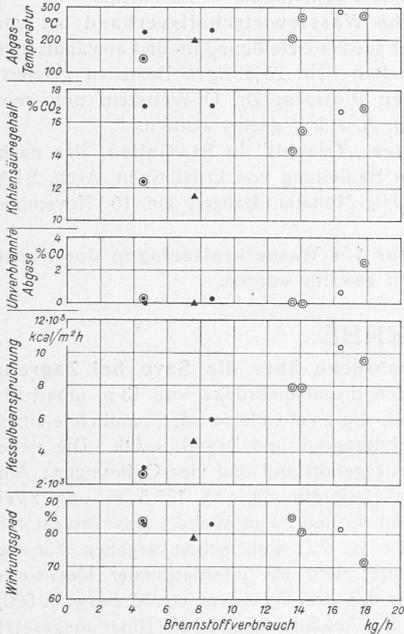
Abb. 3. Versuche mit einem Luwa-Brenner, Typ „Fix“, eingebaut in Warmwasser-Gliederkesseln.
