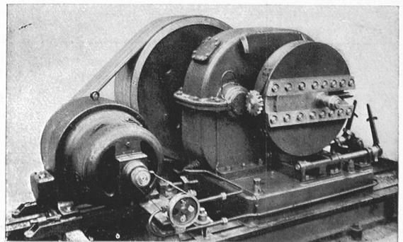
Abb. 6. Motor, Getriebe und verstellbare Antriebskurbel der Wellenmaschine.
