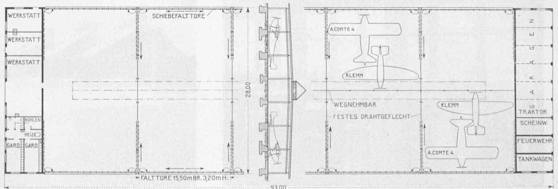
Abb. 17. Sportflugzeug-Hangar auf dem Flugplatz Zürich-Dübendorf. — Grundriss und Schnitt, Masstab 1 : 600.
