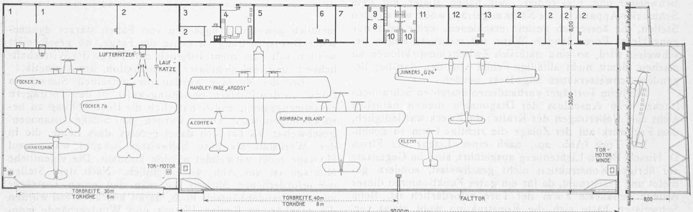
Abb. 21. Grundriss von Werft und Hangar mit ihren Werkstatt-Anbauten, und Schnitt Hangar 1 : 700. — Legende: 1 Allgemeine Werkstätte, 2 Magazin, 3 Technisches Bureau, 4 Heizung, 5 Motorenwerkstatt, 6 Waschraum, 7 Oellager, 8 Schaltraum, 9 Benzinpumpen, 10 Garderoben, 11 Aufenthaltsraum, 12 Sattler und Maler, 13 Schreiner.
