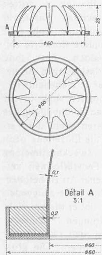
Fig. 3. Clapet, 1 : 3. Coupe, plan et détail.
