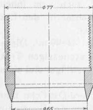
Fig. 2. Couteau tranchant, échelle 1 : 3.
