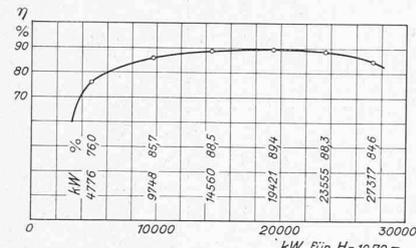
Abb. 7. Gesamtwirkungsgrad der Maschinengruppe 1 in Funktion der Leistung.
