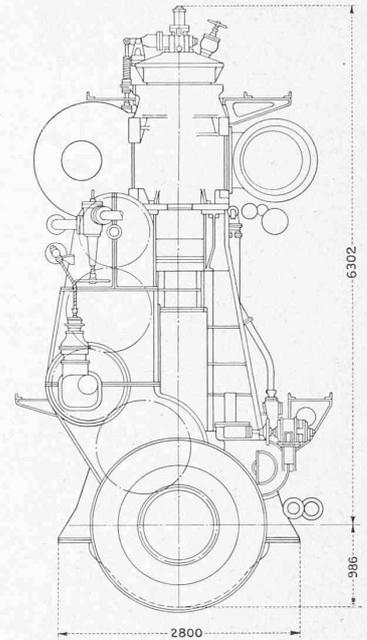
Abb. 5 u. 6. Doppeltwirkender Sulzer-Zweitakt-Schiffsmotor (Versuchsmaschine); 3 Zylinder, 6500 PS<sub>e</sub>, 270 Uml./min. — Masstab 1 : 80.
