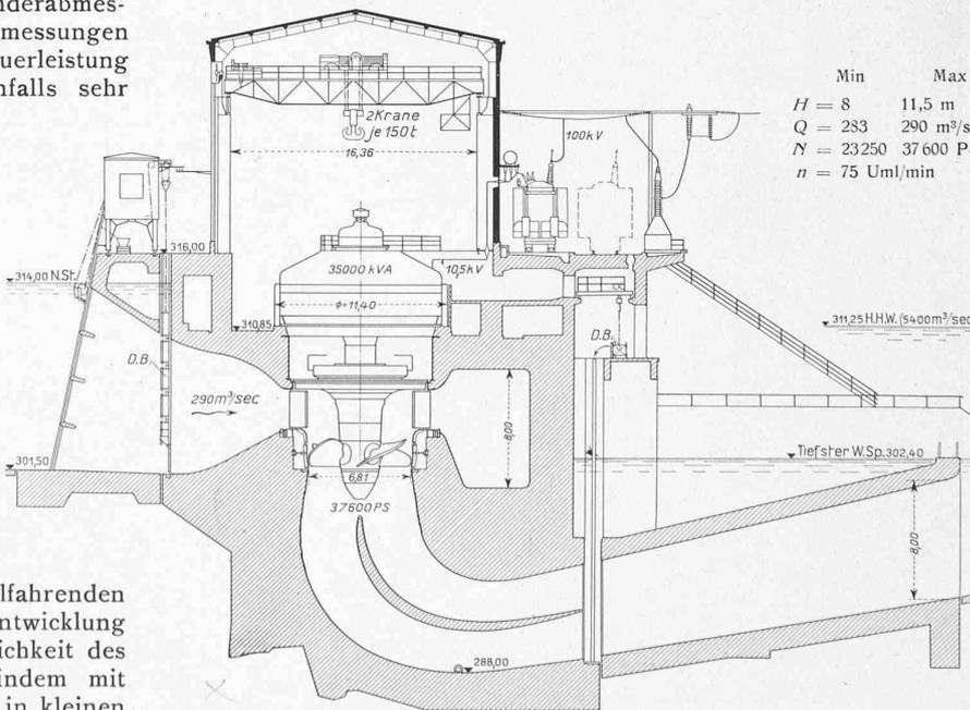
Abb. 3. Schnitt durch das Maschinenhaus des Kraftwerks Albbbruck-Dogern. — Masstab 1 : 500.
