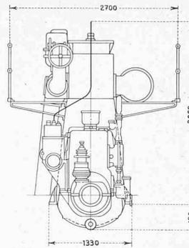
Abb. 1 u. 2. Einfachwirkender Sulzer-Zweitakt-Schiffsmotor (Versuchsmaschine) 3 Zylinder, 1700 PS<sub>e</sub>, 400 Uml/min
