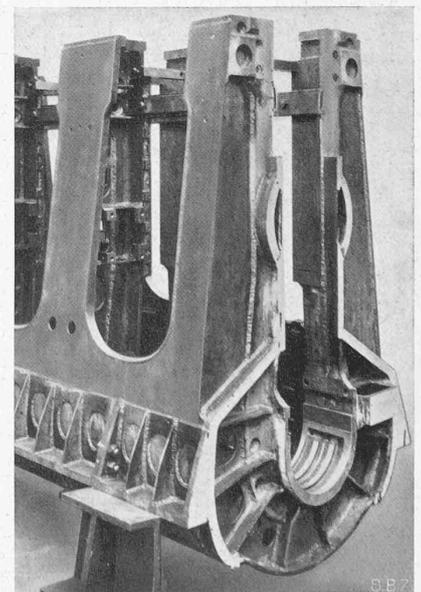
Abb. 3. Geschweisster Rahmen zum Motor Abb. 1.
