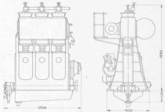
Abb. 9. Doppeltwirkender Sulzer-Zweitakt-Dieselmotor von 1500 PS<sub>e</sub> bei 480 Uml./min. — Masstab 1 : 80.
