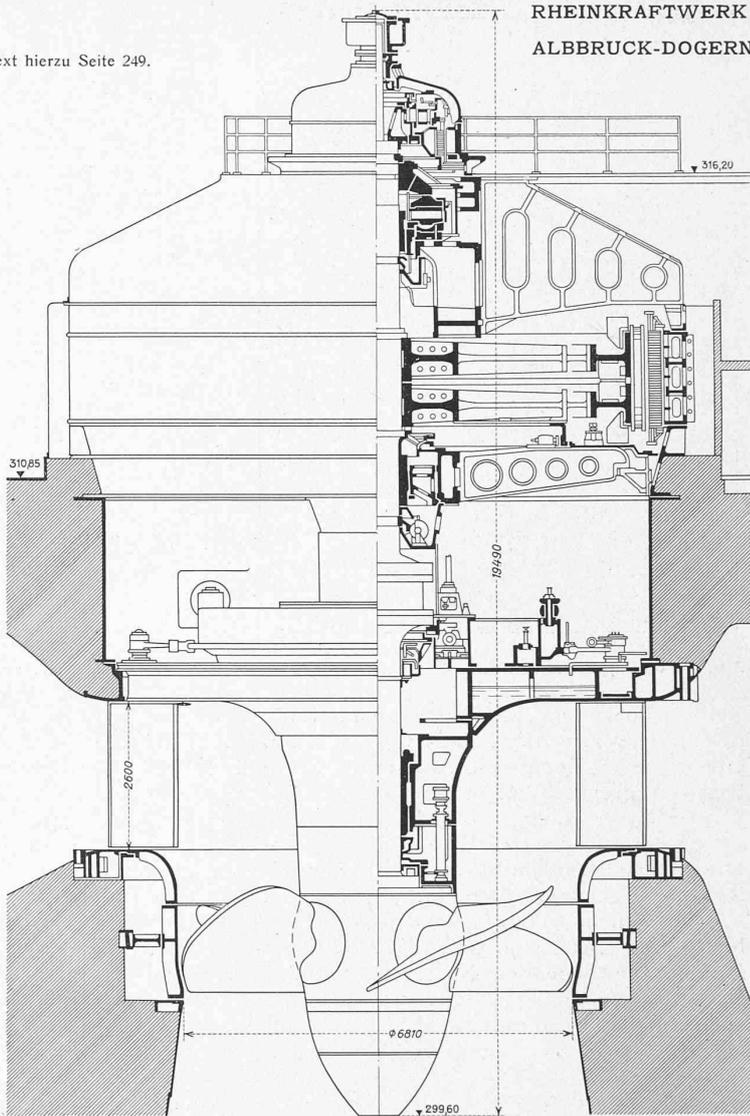
Abb. 4. Vertikalschnitt durch Generator und Kaplan turbine. — Masstab 1 : 120.
