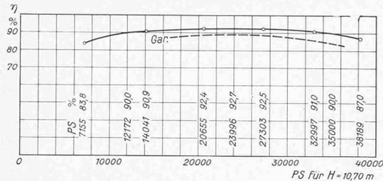
Abb. 6. Wirkungsgrade der Turbine 1 in Funktion der Leistung.
