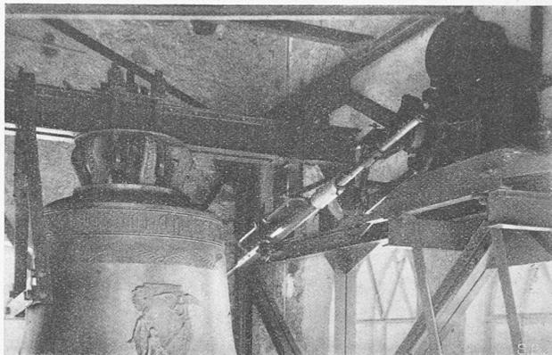
Abb. 4. Ansicht der Läutemaschine System Knell.
