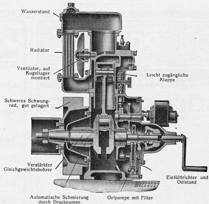
Die VENDEVRE-SCHWERÖL-MOTOREN aus den Werken in DIEPPE ermöglichen HÖCHSTE WIRTSCHAFTLICHKEIT, sowohl hinsichtlich der QUALITÄT wie der MENGE DES BRENNSTOFFES, der verwendet werden kann.
