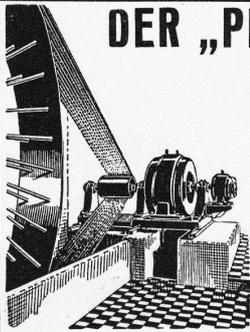
schont Wellen und Lager durch verminderten Riemenzug (Verhältnis 3:1) steigert die Produktion infolge bess. Kraftübertragung (Gleitverlust = 0) erspart an Unkosten für elektrischen Motorenstrom ca. 5-10% vereinfacht die Antriebe durch Wegfall der Spannrollen — erlaubt kürzeste Achsdistanz, spart Platz u Geld.
