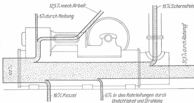
Abb. 2. Wärmebild der Lokomobile aus dem Jahre 1906.
