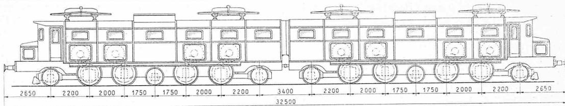
Neuer Schnellzug-Lomotivtyp 1B<sub>0</sub> 1 B<sub>0</sub> 1 + 1 B<sub>0</sub> 1 B<sub>0</sub> 1 von 7200 PS Einstundenleistung für die Gotthardstrecke der S. B. B. — 1 : 200.
