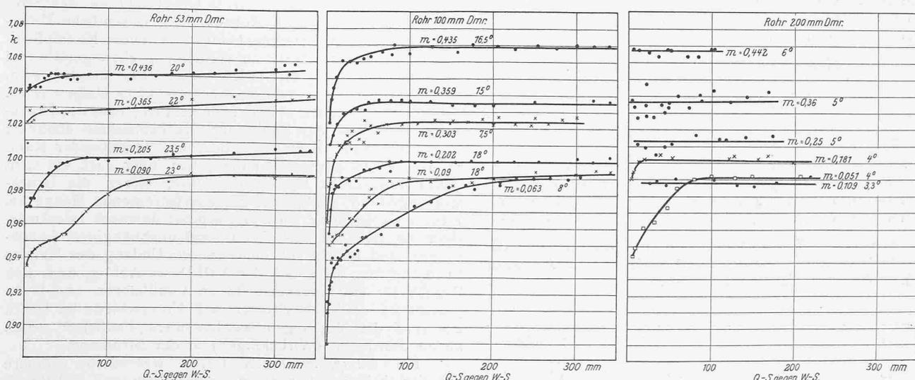
Abb. 2. Ergebnisse der Eichungen von abgerundeten IG-Messscheiben mit Wasser bei verschiedenen Rohrdurchmessern, nach Dr. R. Witte.
