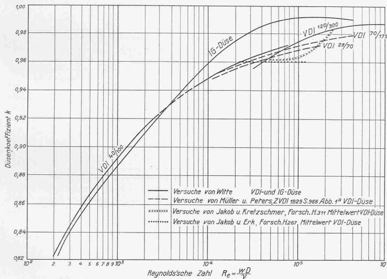
Abb. 1. Durchflusszahlen  $k$  der Normaldüsen, zusammengestellt auf Grund der neuesten Versuchsarbeiten.
