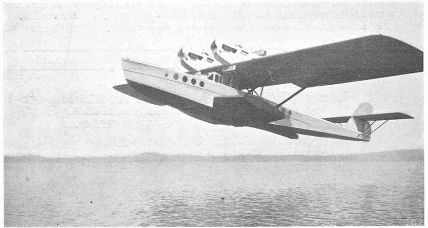
Abb. 1. Seegehendes Flugboot Dornier-Superwal mit vier Motoren, nach dem Start.
