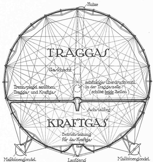
Abb. 10. Luftschiff „Graf Zeppelin“. — Schnitt in Hauptspanntnähe 1 : 350.
