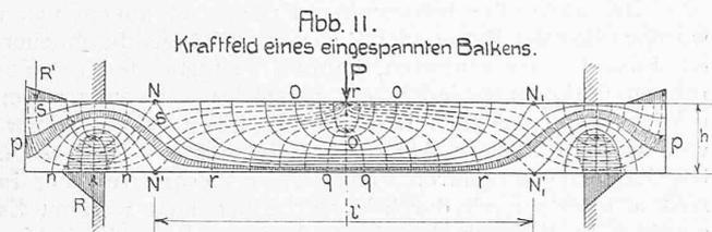
Abb. 11. Kraftfeld eines eingespannten Balkens.
