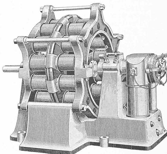
Abb. 4. Kapp'scher Wechselstrom-Generator der M. F. O. 1891.
