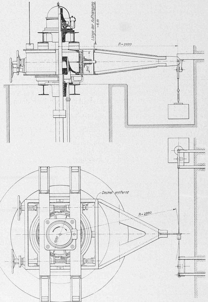
Abb. 18 und 19. Reibungsbremse in der Zentrale Matte in Bern. — Masstab 1 : 50.
