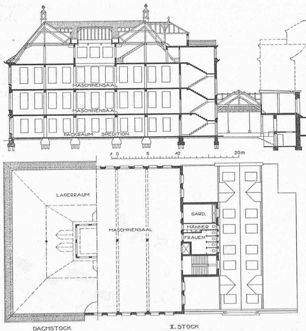
Abb. 10. Grundrisse und Schnitt der Fabrik Hochuli & Cie., 1 : 550.
