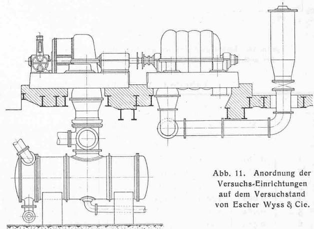
Abb. 11. Anordnung der Versuchseinrichtungen auf dem Versuchstand von Escher Wyss & Cie.
