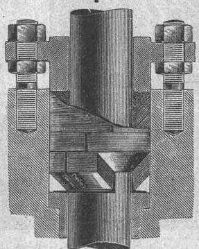
Für Schieber- u. Kolbenstangen, Ventil-Spindeln, Dampfturbinen, Pumpen etc. Für jedes Medium, Gas, Wasser, Dampf, Oel, Säuren etc. verwendbar.
