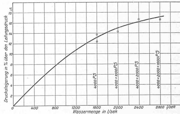
Abb. 15. Drucksteigerung nach Einbau des automatischen Durchlassventils.
