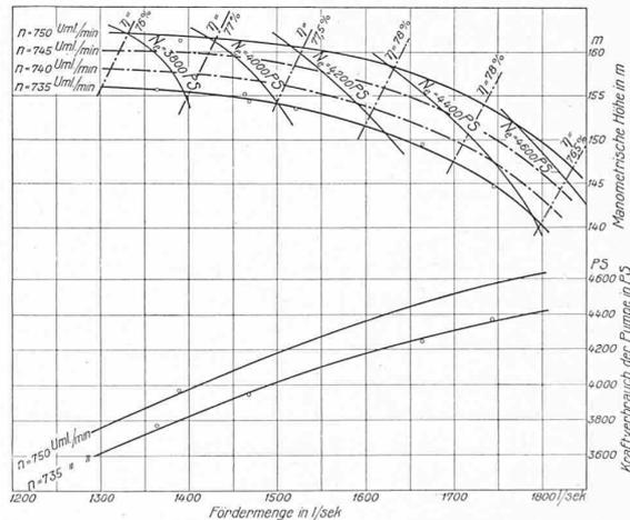
Abb. 9. Charakteristische Kurven der Pumpe von 4500 PS.
