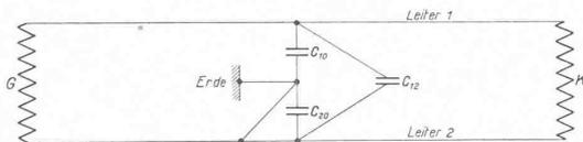
Abb. 3. Einphasen-Stromkreis mit zufälliger Erdung im Leiter 2.
