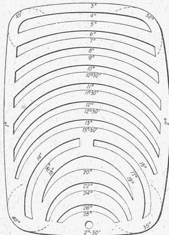
zu bestimmen. Der mit  $1^\circ$  bezeichneten Kurve grössten Halbmessers entspricht somit ein Radius von  $1745,71 m$ , der mit  $45^\circ$  bezeichneten kleinsten Halbmessers ein solcher von  $39,79 m$ . Im gebräuchlichen Masstab  $1:1000$  würde das Plättchen bei Beibehaltung der nebenstehenden Anordnung etwa  $44 cm$  hoch und  $31 cm$  breit werden.
