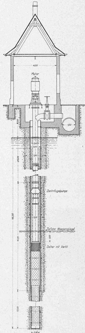
Abb. 2. Rohrbrunnen mit Zentrifugalpumpe. — Masstab 1:150.
