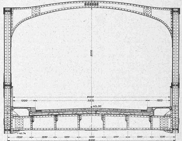
Versteifungsbalken. Die ganze Lösung ist einfach gehalten. Auch hier wäre die Anordnung eines vollwandigen Versteifungsbalkens unter den Gehwegen vorteilhafter, d. h. die Fahrbahn müsste gegenüber den Hauptträgern gehoben werden, ohne an den Verhältnissen der letzteren etwas zu ändern. Die Querschnittanordnung der Gurtungen könnte verbessert werden.
