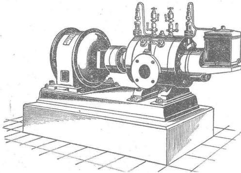
Direkte Kupplung mit Elektromotoren oder Riemenbetrieb.
