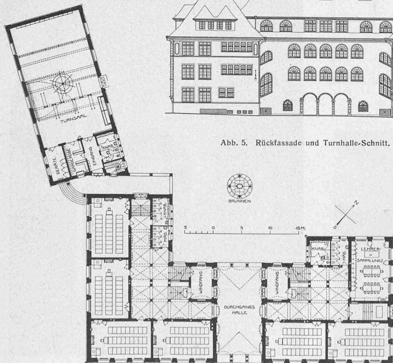
Abb. 1. Erdgeschoss-Grundriss des Letten-Schulhauses samt Turnhalle. — 1:600.
