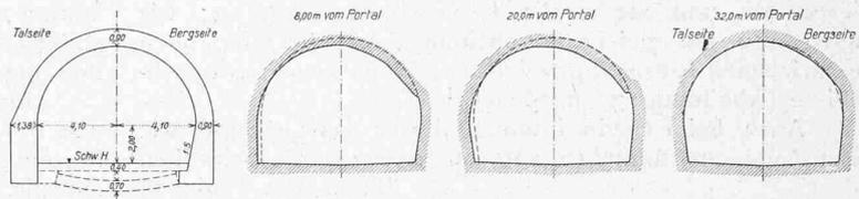
Abb. 54 bis 57. Tunnelprofil und Deformationen im Sevistein-Tunnel II. — 1:400.
