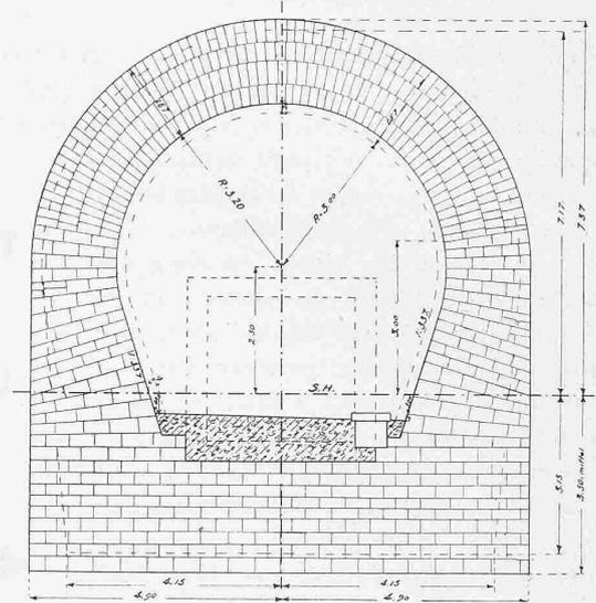
Abb. 3. Mauerungsprofil Typ IX der Druckstrecke. — 1 : 150.
