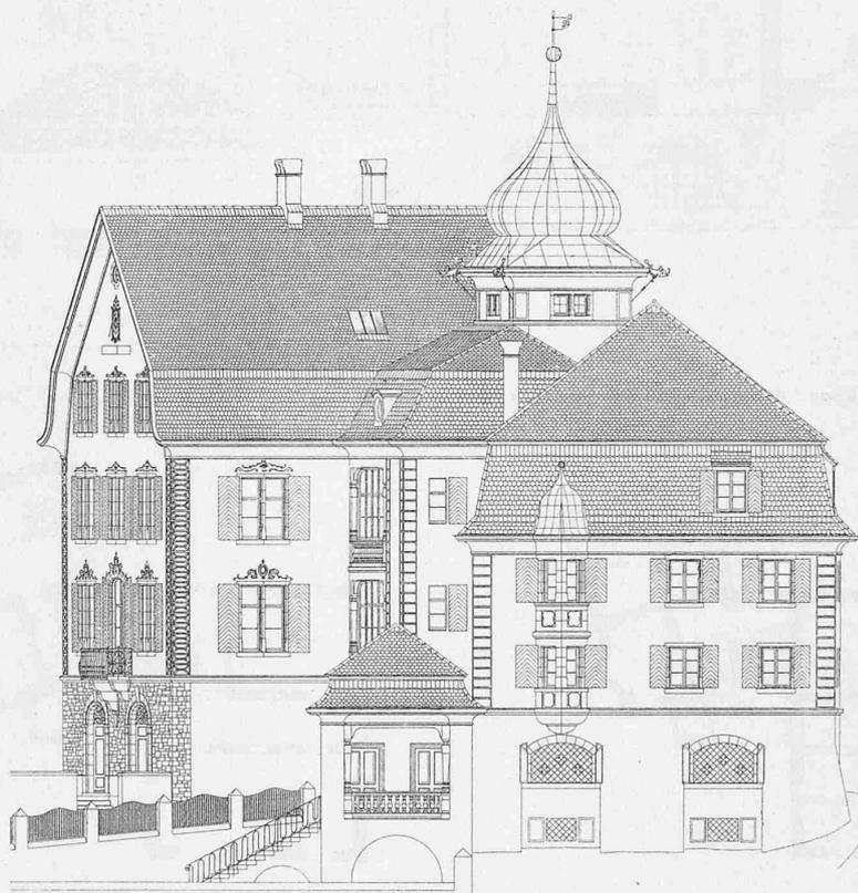
Abb. 5. Ostfassade des «Schlössli» in Tamins. — Masstab 1 : 250
