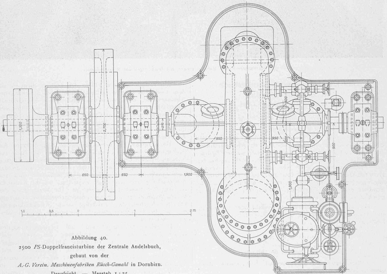
Der die Fink'schen Leitschaufeln bewegende, kräftige Reguliererring ist auf Kugeln gelagert und steht mit dem äusseren Reguliergetriebe durch zwei Kurbellaschen in Verbindung. Die Regulierwellen aus Stahl mit aussenliegendem Schmierkopf sind in der Axe der Verbindungsstange zentral gelagert, sodass Biegungsspannungen vermieden sind. Zu diesem Zwecke sind die Stahlgusshebel in der Mitte entsprechend ausgespart.
