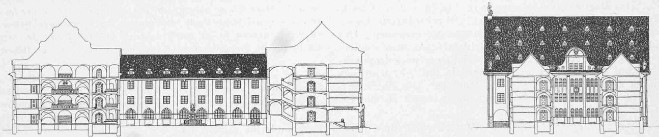
Längsschnitt des Bezirksgebäudes, Masstab 1:800, und Querschnitt dazu.
