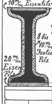
**Schalldämpfung im Hochbau wird erreicht durch Isolierung der Träger mit**
