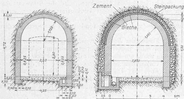
Abb. 18 und 19. Normales und verstärktes Tunnelprofil. — 1 : 150.
