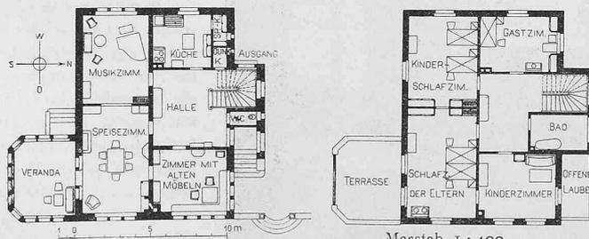
Abb. 2 und 3. Grundrisse vom Erdgeschoss und ersten Obergeschoss.
