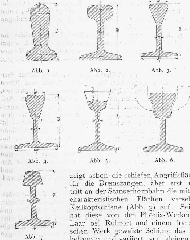
zeigt schon die schiefen Angriffsflächen für die Bremszangen, aber erst 1889 tritt an der Stanserhornbahn die mit den charakteristischen Flächen versehene Keilkopfschiene (Abb. 3) auf. Seither hat diese von den Phönix-Werken in Laar bei Ruhrort und einem französischen Werk gewalzte Schiene das Feld behauptet und variiert, von kleinen Abänderungen bzw. Verbesserungen ab-
