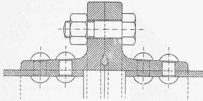
Abb. 8. Flanschendichtung der Rohrleitung (System Gebrüder Sulzer). — 1 : 5.
