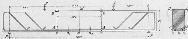
Abb. 1. Abmessungen und Bewehrung der Versuchskörper.
