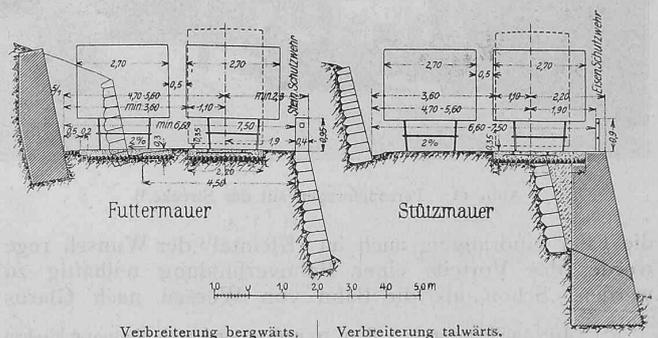
Abb. 3. Strassenprofile mit Verbreiterung. — Masstab 1 : 200.
