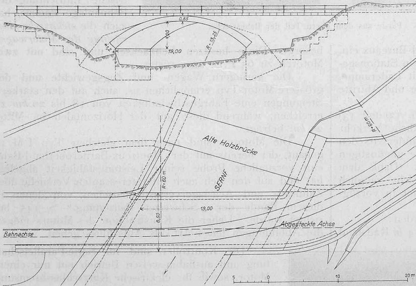
Abb. 4. Strassenverlegung und Neubau der Brummbachbrücke. — Masstab 1 : 500.
