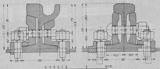
Abb. 6. Schienenprofile der Sernfthalbahn. — 1 : 5.
