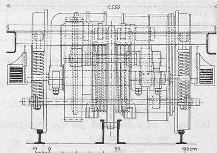
Abb. 8. Drehgestell. Schnitt durch die Mitte. — 1 : 25.
