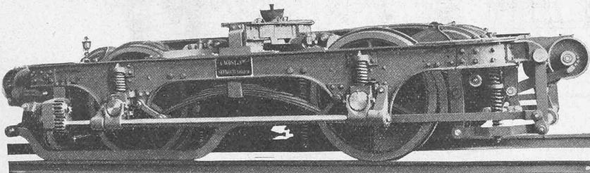
Abb. 3. Ansicht des Treibachsen-Drehgestells von der Seite.
