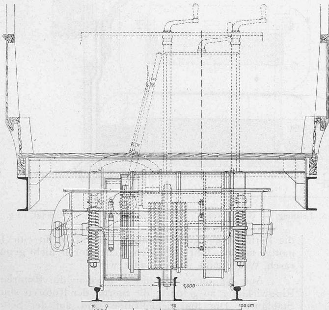
Abb. 7. Drehgestell. Schnitt durch die Plattform. — 1 : 25.
