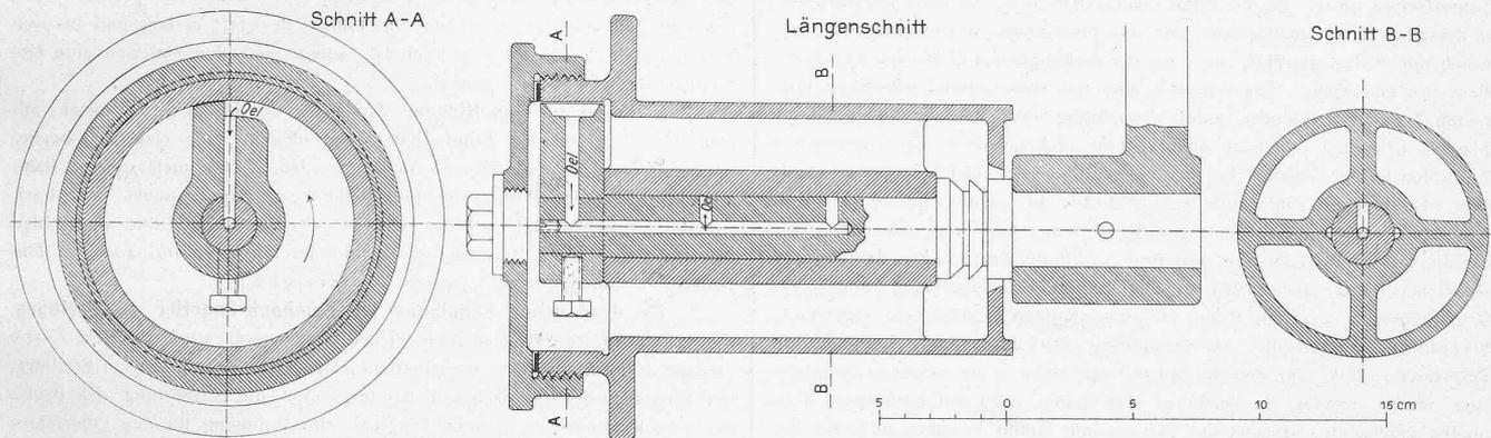
Abb. 15. Automatische Oelschmierung der Spannrolle. — Masstab 1 : 3.
