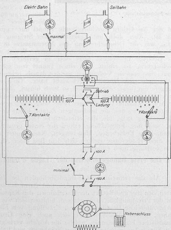
Abb. 13. Schaltungsschema der Zentrale am Staubach.
