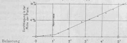
Der Parallelversuch einer reinen Betonplatte ohne Einlage ergibt eine Zugfestigkeit des Betons von  $28,6 \text{ kg/cm}^2$  und beweist, dass unsere schweizerischen Cemente den
