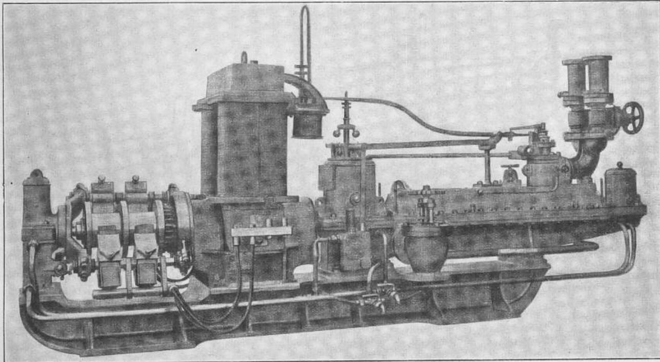
Fig. 11. Parsons-Turbo-Alternator von 350 kw mit Erreger.
