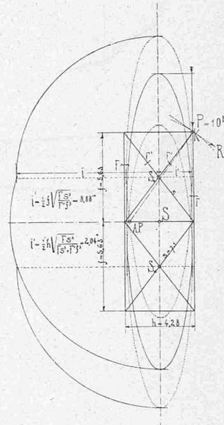
Fig. 6. Höchster Pfeiler der Adelboden-Brücke.
