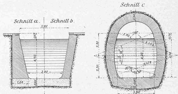
Fig. 2. Profil des Zuflusskanals und Tunnels. 1:200.
