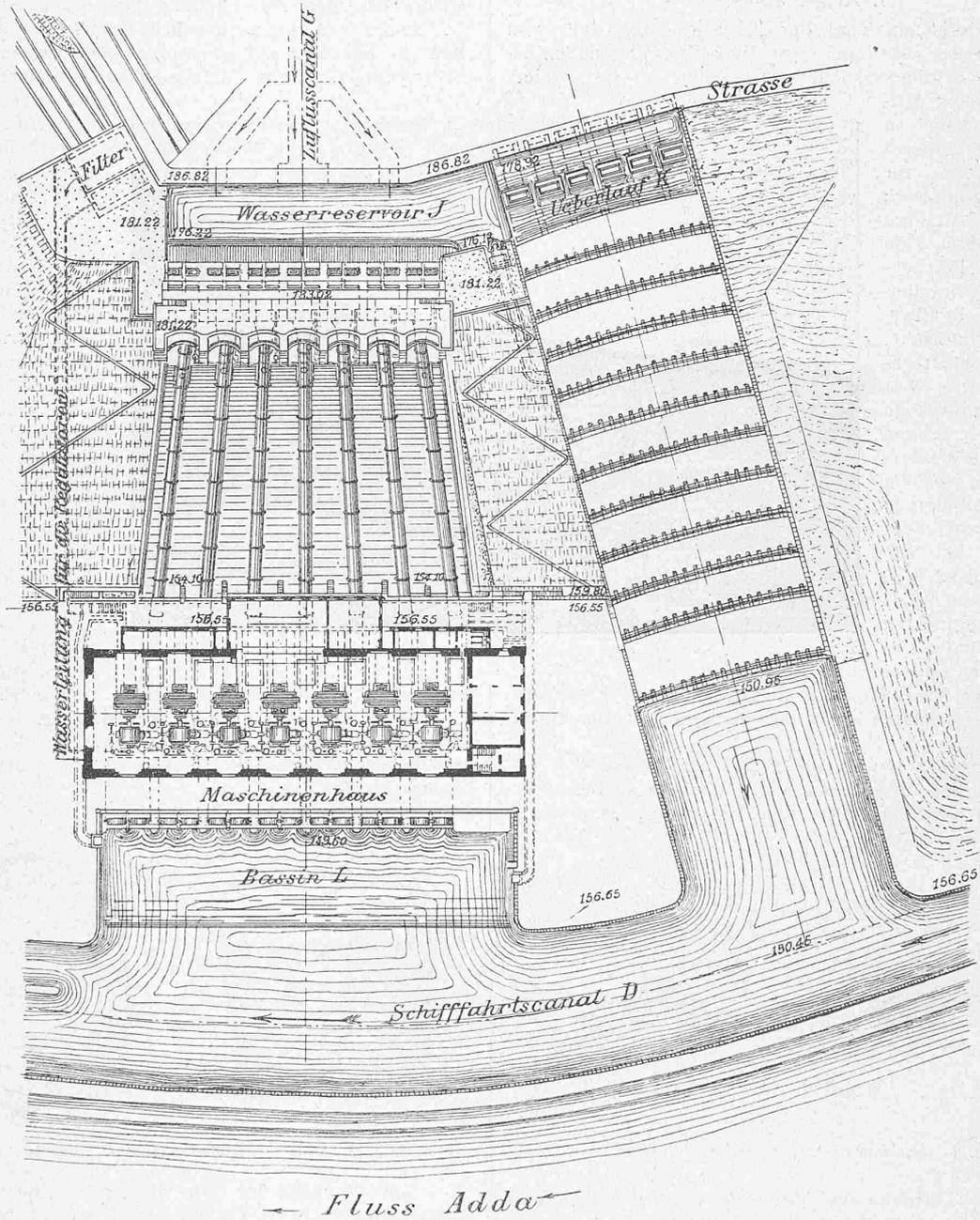
Fig. 3. Grundriss der gesamten Turbinenanlage. 1:1000.
