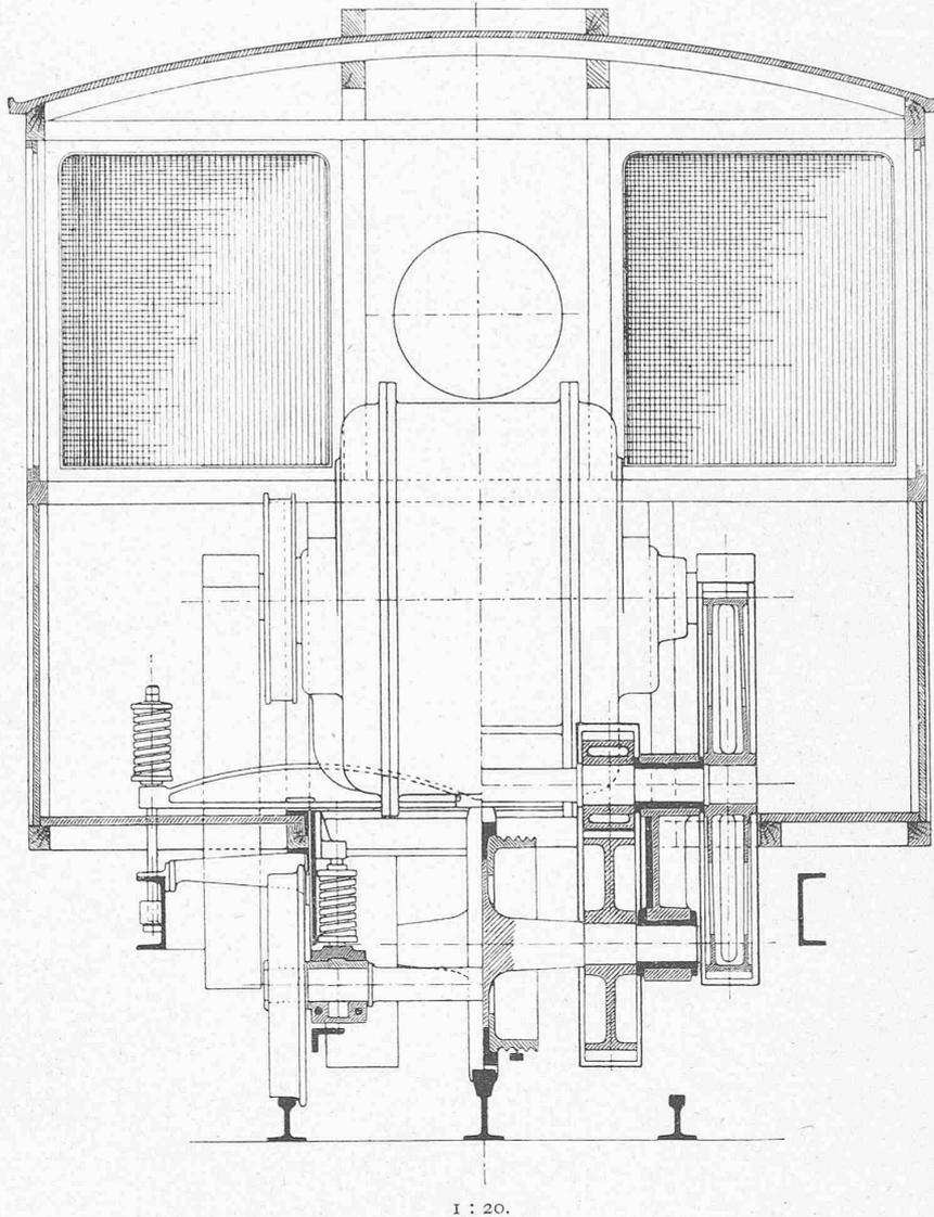
Legende: Spurweite 1000 mm. Maximalsteigung 250 ‰. Durchmesser des Triebzahnades 700 mm. Anzahl der Triebräder 2. Durchmesser der Laufräder 600 mm. Fahr-Geschwindigkeit in der Stunde 8,5 km. Maximalzahndruck 6500 kg. Leistung der Dynamos 250 P. S. Umdrehungszahl 800. Gewicht der Maschine 13 t.
